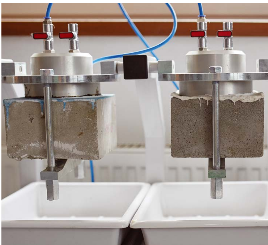
Fot. 2. Próbkę jednokomponentowego wyrobu na bazie spoiwa polimerowego podczas badania wodoszczelności
