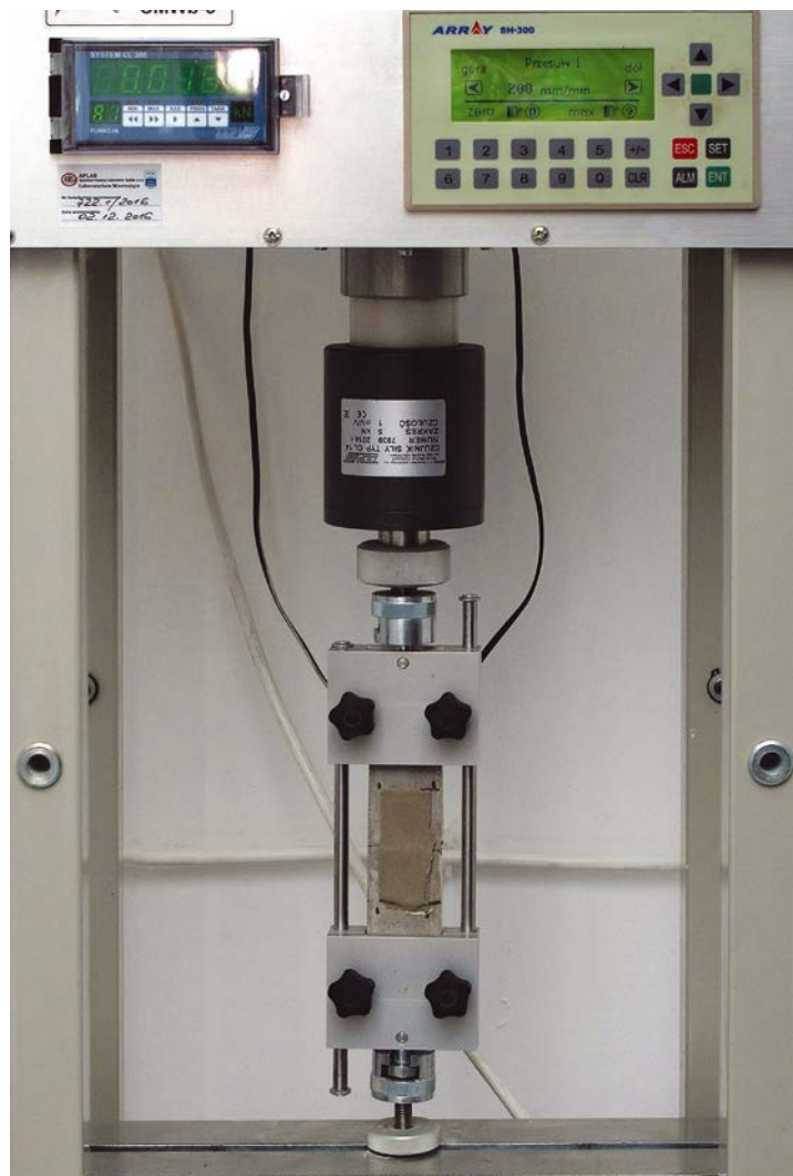
Fot. 1. Próbkę jednokomponentowego wyrobu na bazie spoiwa cementowego podczas badania zdolności do mostkowania pęknięć w warunkach znormalizowanych
