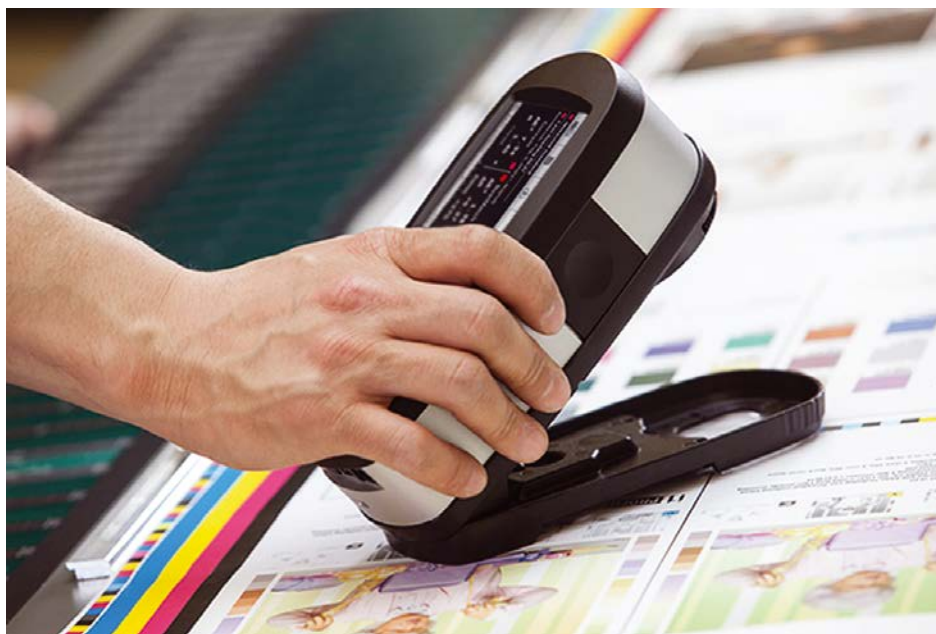
Wyniki dostarczane przez spektrofotometry o geometrii pomiaru 45^\circ/0^\circ najlepiej odzwierciedlają percepcję kolorów przez ludzkie oko
